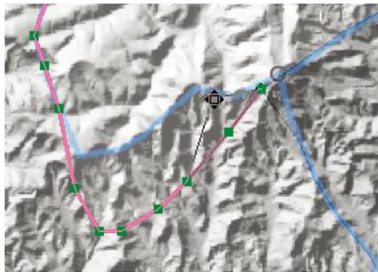
Puede cambiar la forma de este eje vértice a vértice, pero hay una forma más rápida de actualizarlo.
